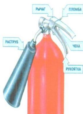
■ Углекислотные огнетушители предназначены для тушения загораний различных веществ и материалов, а также электроустановок, кабелей и проводов, находящихся под напряжением до 1000В
